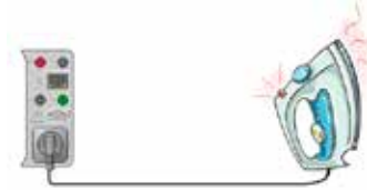
Prüfung des PE-Leiter-Ableitstroms für Geräte der Klasse I
