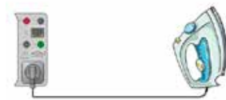
Isolationswiderstandsprüfung für Geräte der Klasse I
