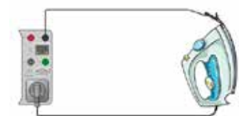
Ersatzableitstromprüfung für Geräte der Klasse I
