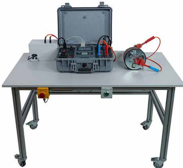
S 2115 Sicherheitssystem mit Strombegrenzungs-Itest < 3mA
