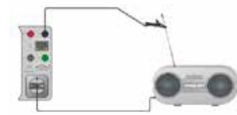
Isolationswiderstandsprüfung für Geräte der Klasse II
