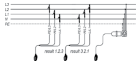
Schaltung für Spannungsmessungen, Frequenz und Phasenfolge
