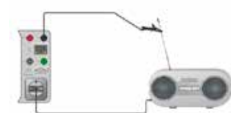
Ersatzableitstromprüfung für Geräte der Klasse II
